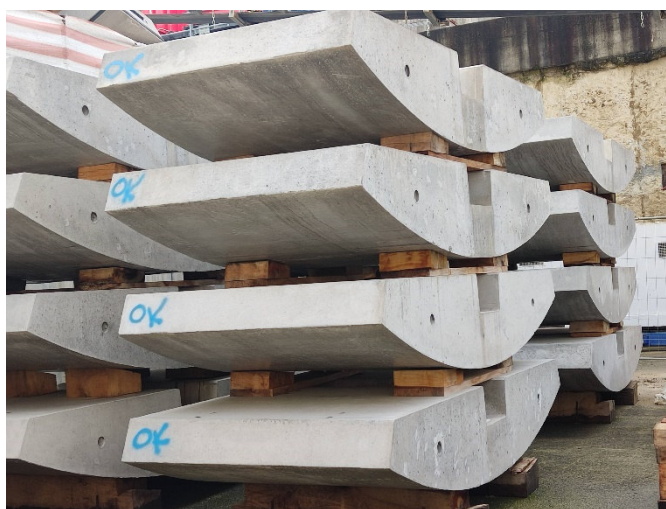
Basamento per successivo alloggiamento binari
