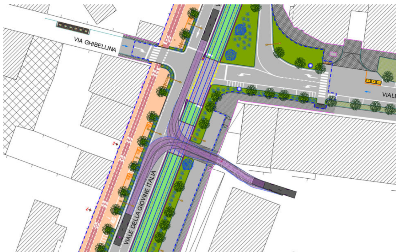
Bus 12 m – Svolta viale della Giovine Italia civ.2 (passo carraio caserma Baldissera dei Carabinieri)
