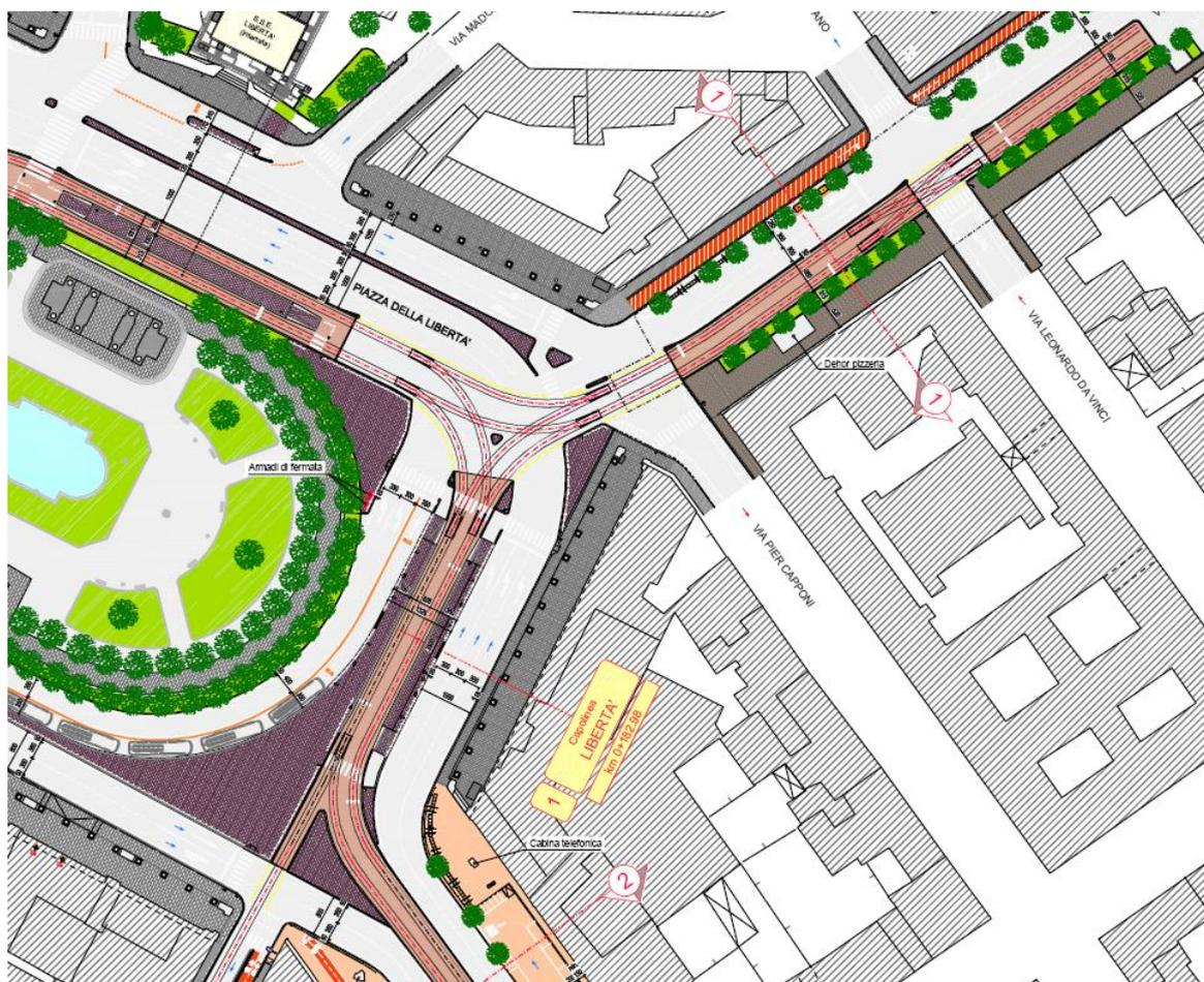
Il nuovo capolinea della linea 3.2.1 Libertà- Bagno a Ripoli, a differenza di quanto previsto dal progetto del Dicembre 2019, è ora posizionato sul lato corto di piazza della Libertà. Questa nuova dislocazione, oltre a permettere una rottura di carico tra le linee più efficace e breve,
