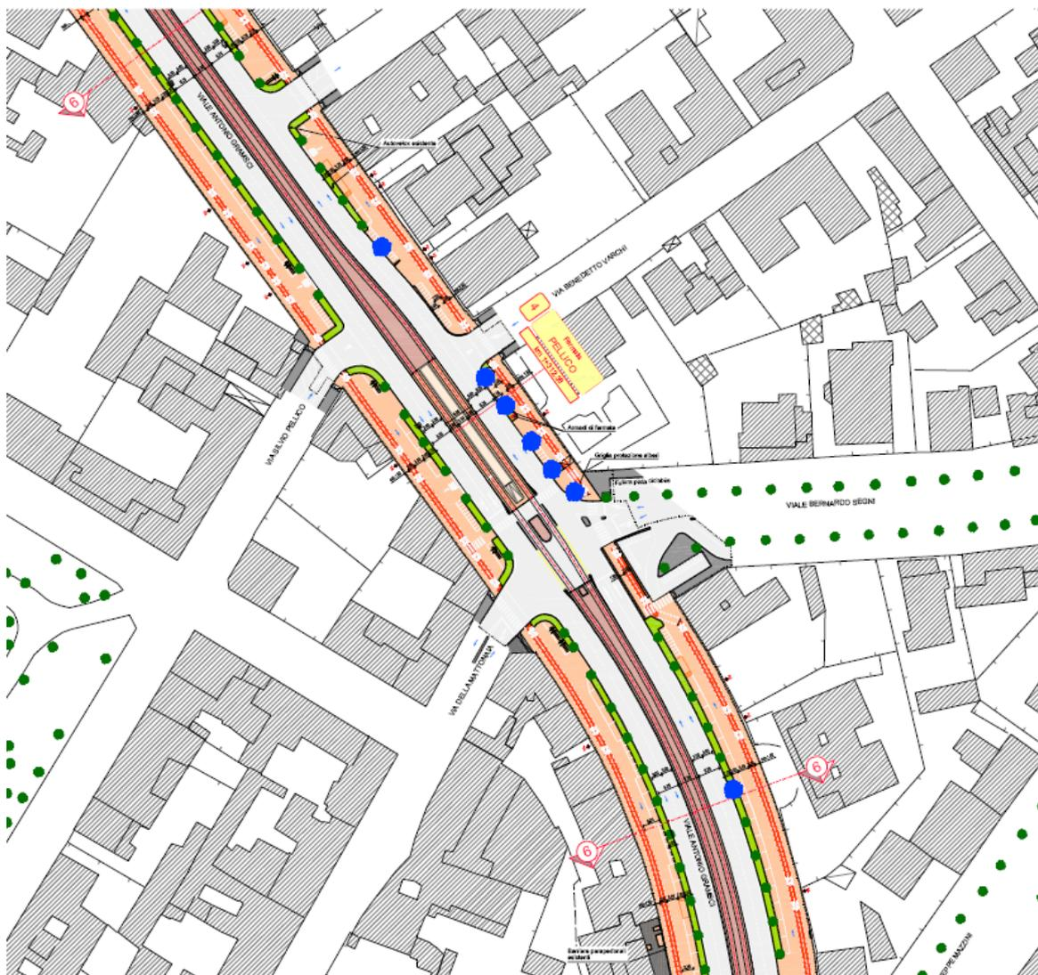
Per la geometria attuale del viale la separazione della sede tramviaria da quella carrabile è effettuata tramite l'inserimento di un cordolo, mentre sono previsti per quanto riguarda la sistemazione del verde tre tipologie di intervento: conservazione delle piante, necessari reimpianti e la piantagione di nuove siepi a margine dei viali.
