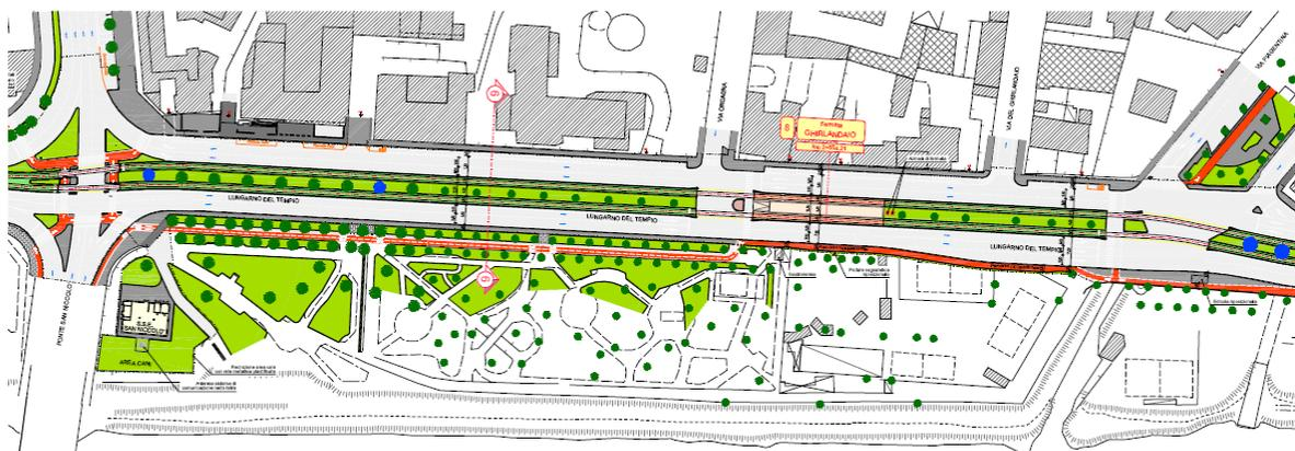
La sistemazione planimetrica della sede della tramvia prosegue poi in asse lungo il lungarno del Tempio, attraversando l'incrocio all'altezza del ponte San Niccolò, e sviluppandosi a cavallo dell'aiuola spartitraffico esistente, in maniera conciliabile alla presenza e al mantenimento degli attuali tigli presenti in centro strada.
