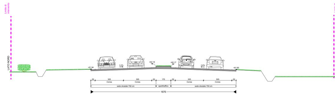
SEZIONE TIPO 22 - PROGETTO - scala 1:100
