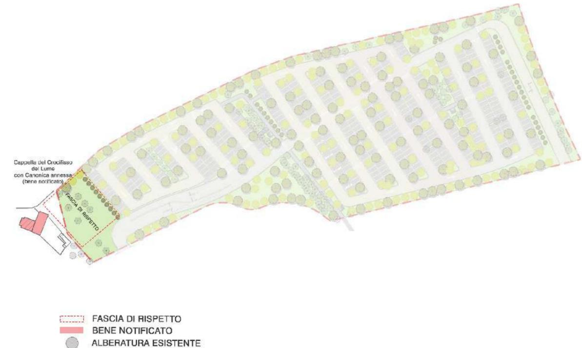
la funzionalità ecologica sono stati mantenuti i filari di piante esistenti ed i parcheggi sono stati progettati tenendo conto dell'attuale giacitura dei terreni, preservando la suddivisione dei campi, limitando al massimo gli abbattimenti e cercando di mantenere quante più alberature esistenti possibile.
