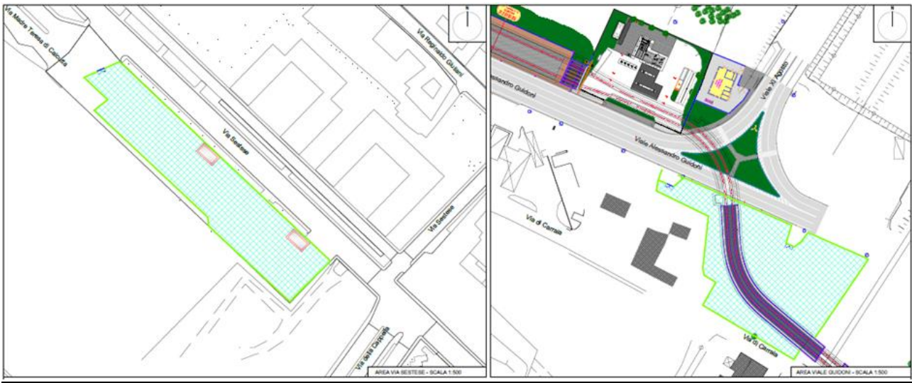
Figura 48 -aree stoccaggio fisse già allestite nell'ambito della realizzazione delle linee tranviarie.
