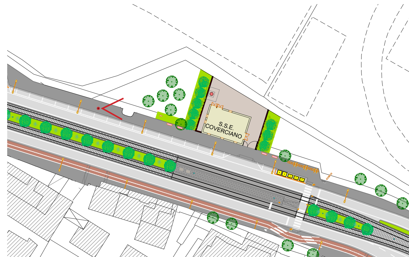
Sotto-stazione elettrica Coverciano: Planimetria generale
