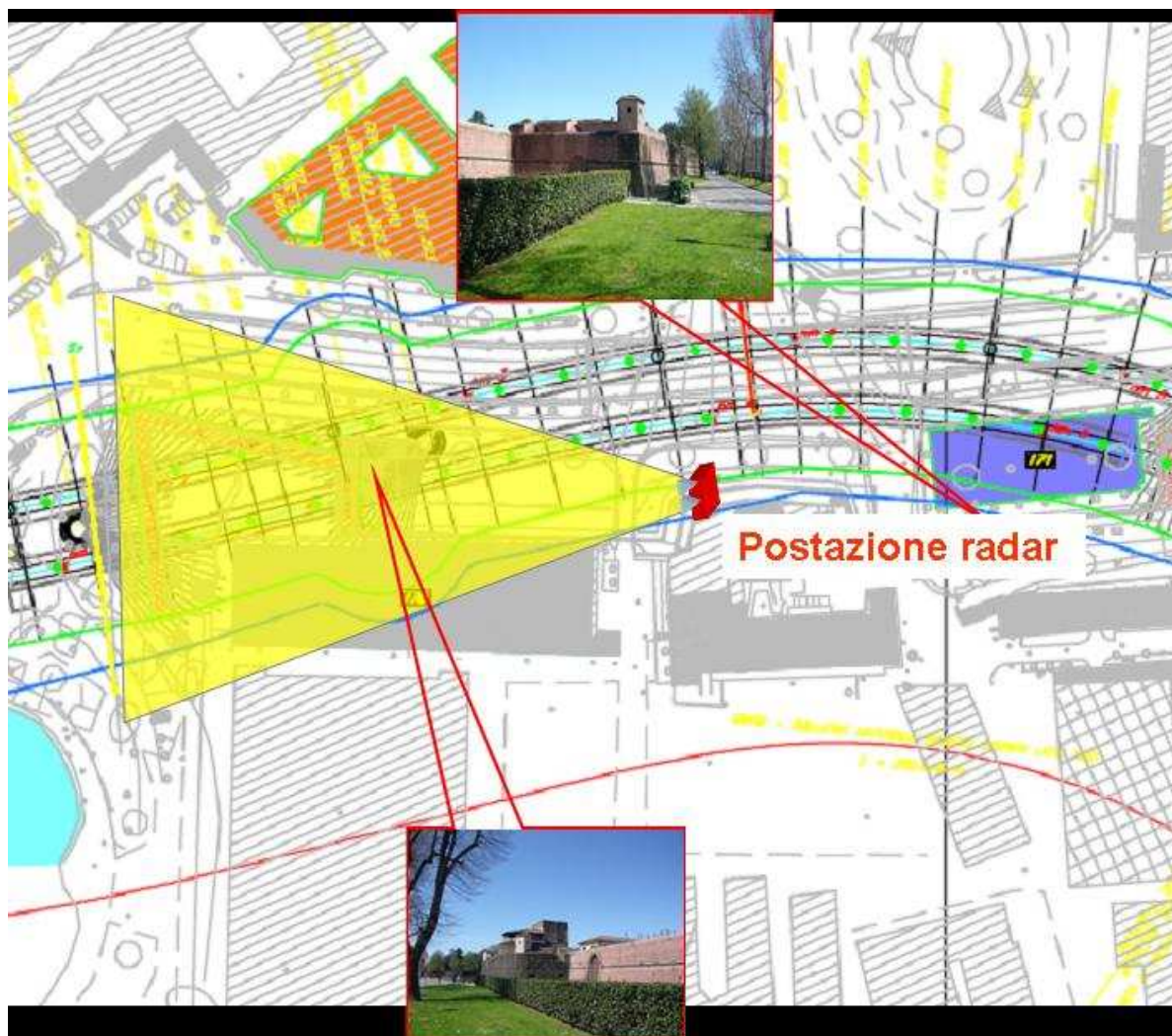
Fig.5: possibile postazione per l'installazione del radar per il monitoraggio bastione est della Fortezza.
