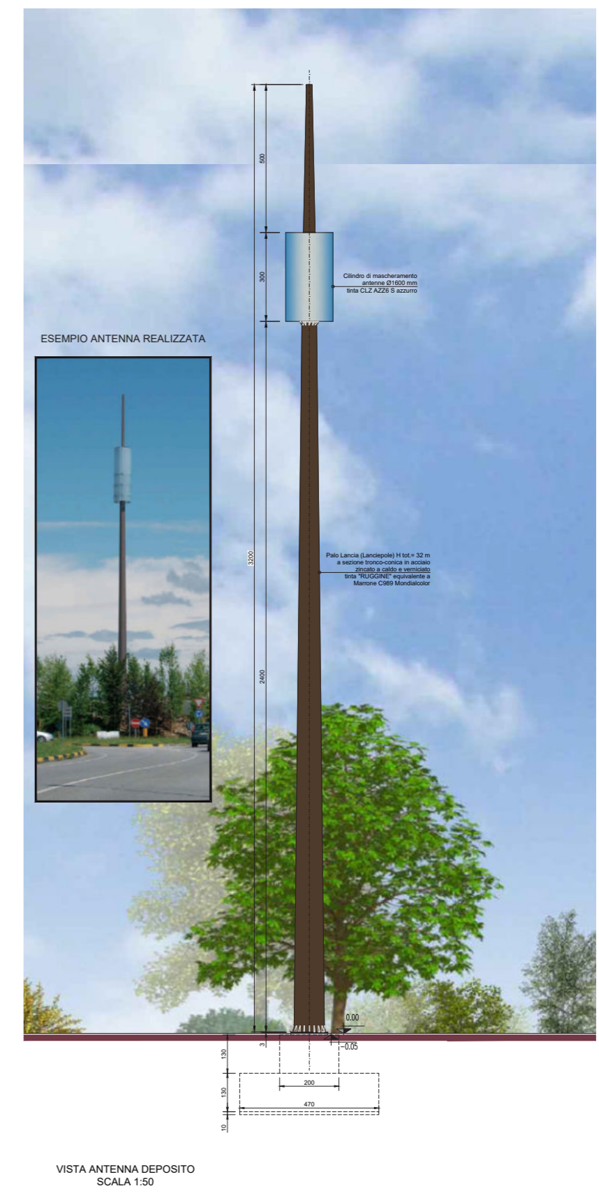
Posizionamento planimetrico delle antenne radio; prospetto della torre radio del deposito
