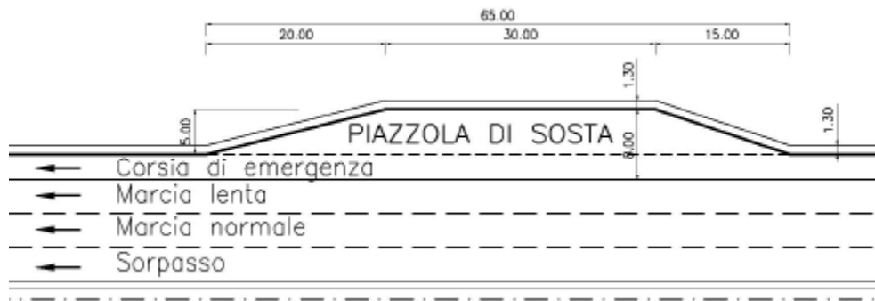
Figura 8-5: - Piazzole di sosta in rilevato/trincea
