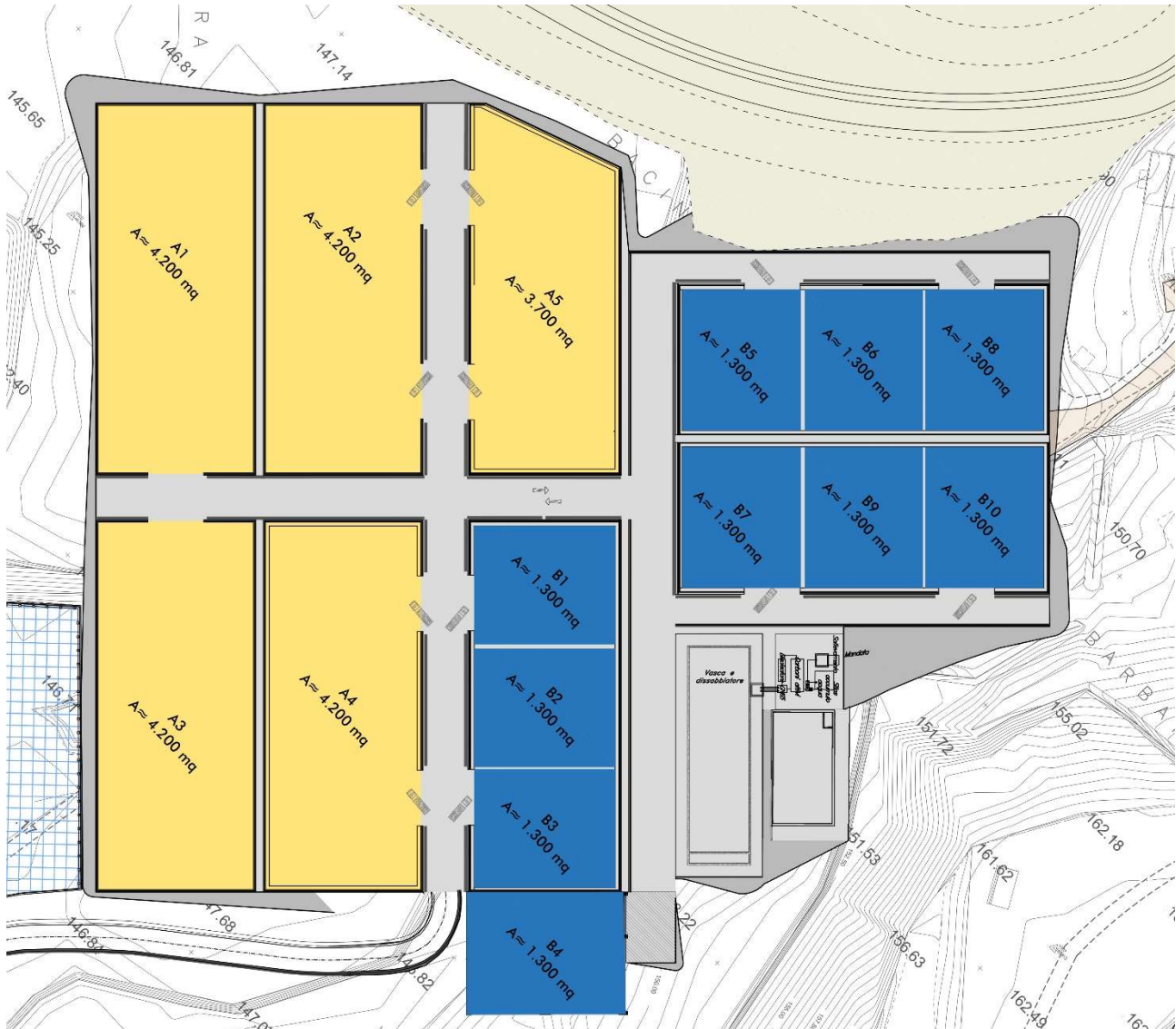
Figura 4 - Configurazione futura per la gestione delle TRS provenienti dallo scavo meccanizzato
