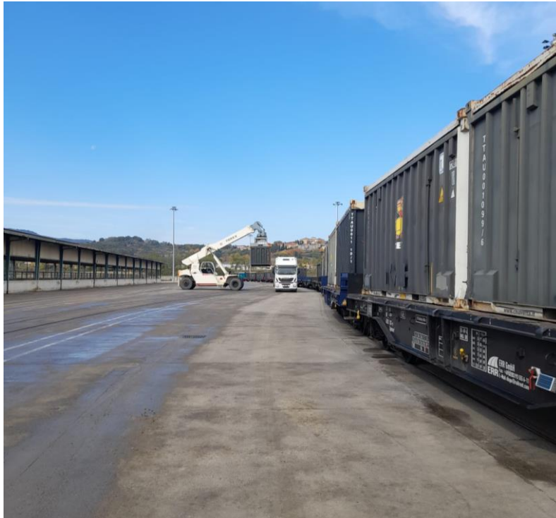
Foto 07 – Scarico containers ferroviari tramite Reach stackers
