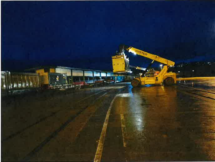
Foto 07 – Scarico containers ferroviari tramite Reach stackers
