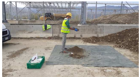
Fase di vagliatura del terreno prelevato
