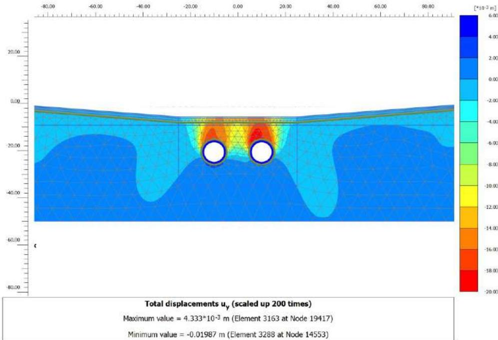
*Figura 11-86 Infrastruttura L. Modello SS - rampa. Risultati. Campo deformativo. Scavo BP+BD*
