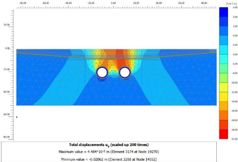
Figura 11-84: Infrastruttura L. Modello SS. Risultati. Campo deformativo. Scavo BP+BD
