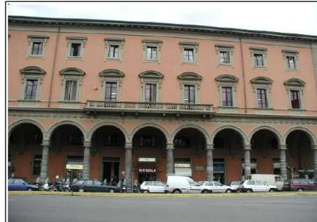
Il fabbricato 091 presenta colonne poste ad interasse pari a 5,0m lungo il lato prospiciente piazza della Libertà. Nella di valutazione della distorsione si tiene conto dell'obliquità dell'allineamento di colonne rispetto alla direzione delle gallerie. Le subsidenze vengono valutate in funzione della distanza fra le gallerie ed ogni colonna, perpendicolarmente alla galleria. L'interasse fra le colonne viene misurato lungo l'allineamento obliquo corrispondente alla facciata dell'edificio.
