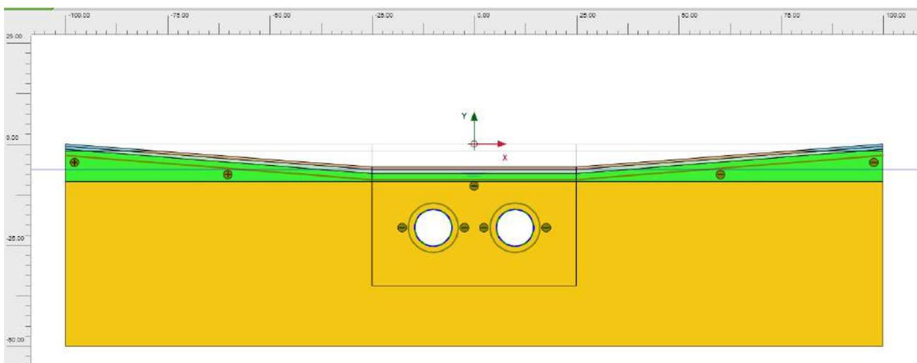
*Figura 11-72: Modello di calcolo infrastruttura L con rampa*
