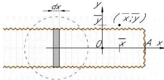
**Figura 6-5. Vista in pianta della galleria in costruzione. Dominio bidimensionale per la stima dei cedimenti**
