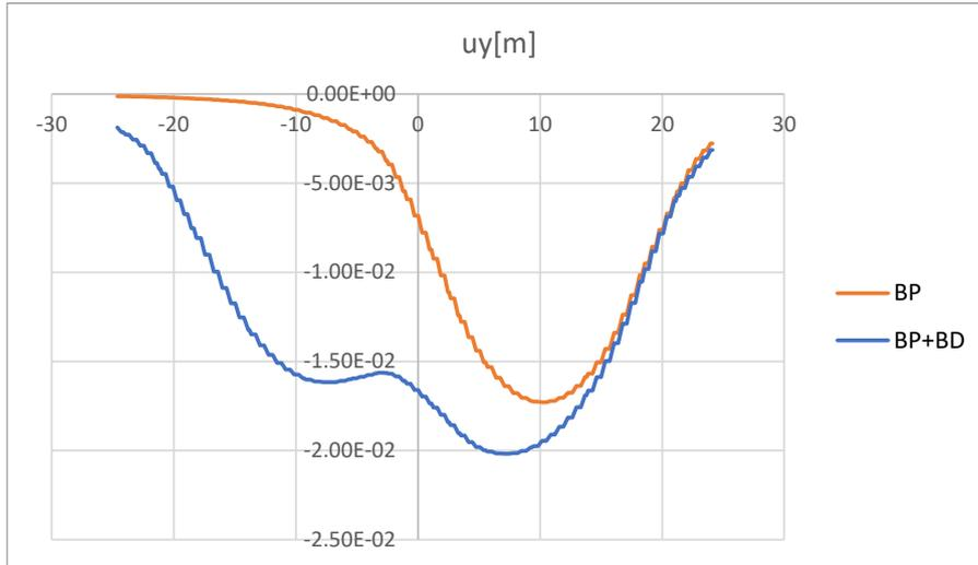
Figura 11-41: Infrastruttura M. Modello SS. Risultati. Spostamenti verticali
