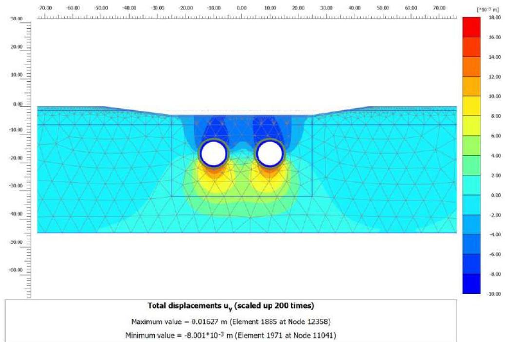
Figura 11-28: Infrastruttura M. Modello MC. Risultati. Campo deformativo. Scavo BP+BD
