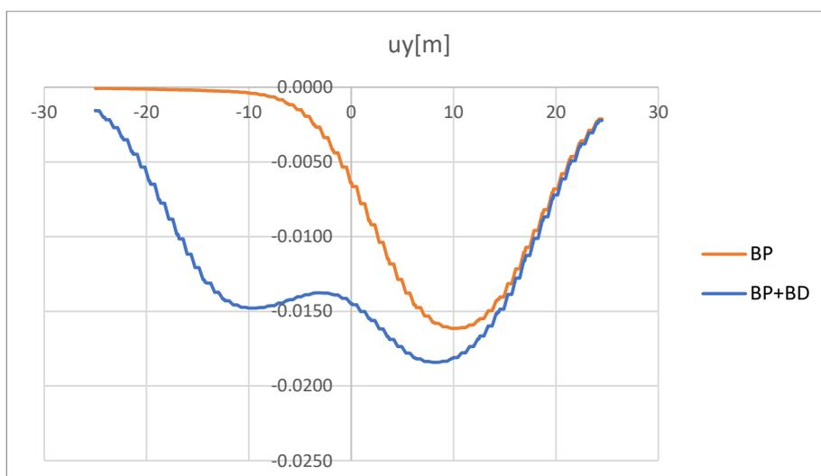
Figura 11-67: Infrastruttura A. Modello SS-rampa. Risultati. Spostamenti verticali
