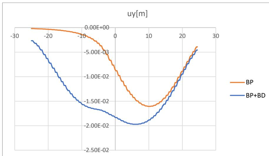
Figura 11-64: Infrastruttura A. Modello SS. Risultati. Spostamenti verticali
