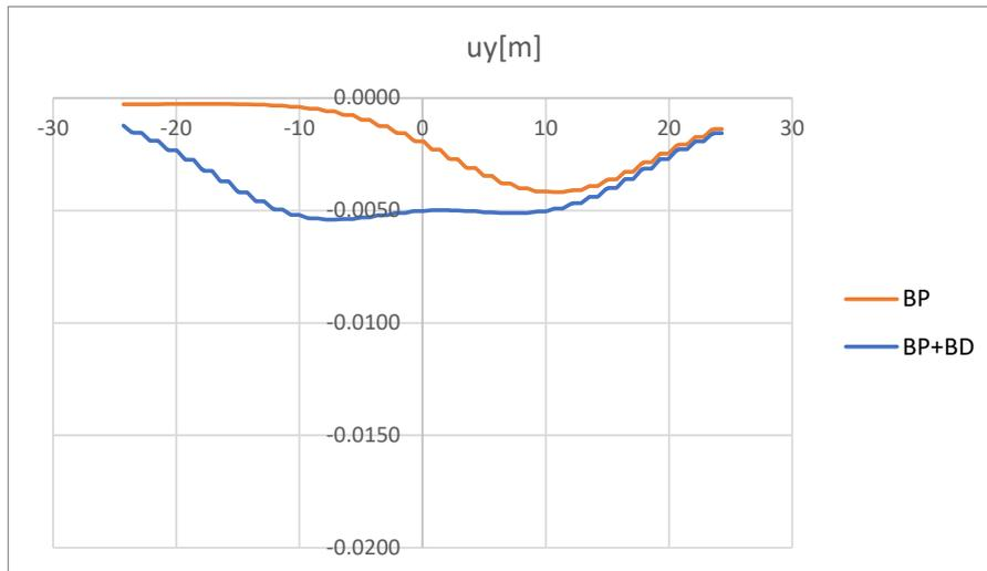
Figura 11-80: Infrastruttura L. Modello MC-rampa. Risultati. Spostamenti verticali
