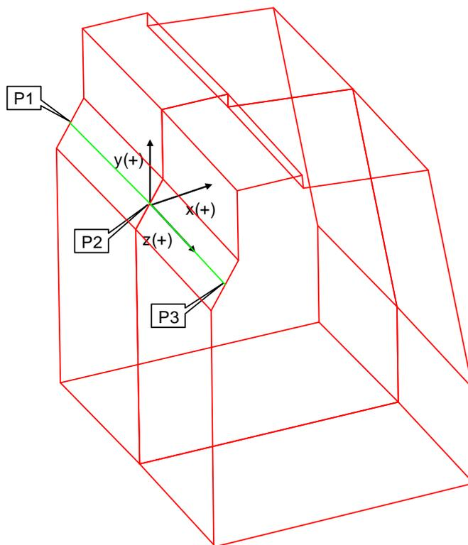
Figura 9-2. Schema spalla e punti di controllo spostamento
