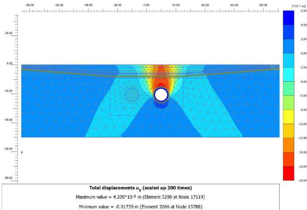
*Figura 11-83: Infrastruttura L. Modello SS. Risultati. Campo deformativo. Scavo BP*
