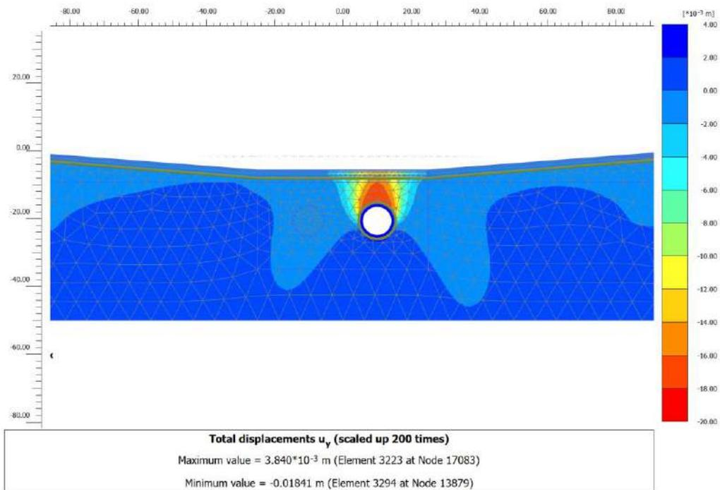
Figura 11-85: Infrastruttura L. Modello SS - rampa. Risultati. Campo deformativo. Scavo BP
