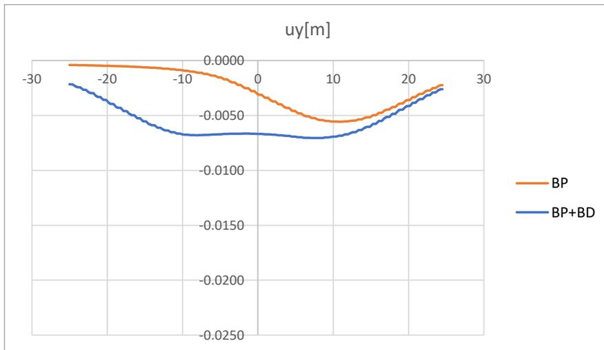
Figura 11-57: Infrastruttura A. Modello MC-rampa. Risultati. Spostamenti verticali
