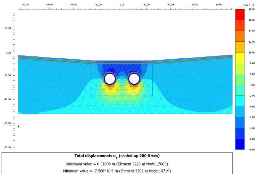
Figura 11-76 Infrastruttura L. Modello MC - rampa. Risultati. Campo deformativo. Scavo BP+BD
