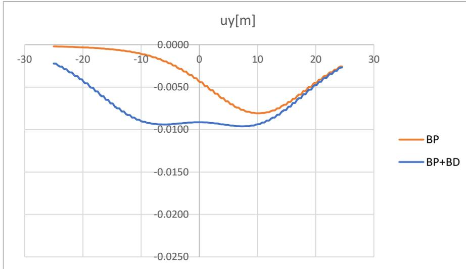
Figura 11-54: Infrastruttura A. Modello MC. Risultati. Spostamenti verticali
