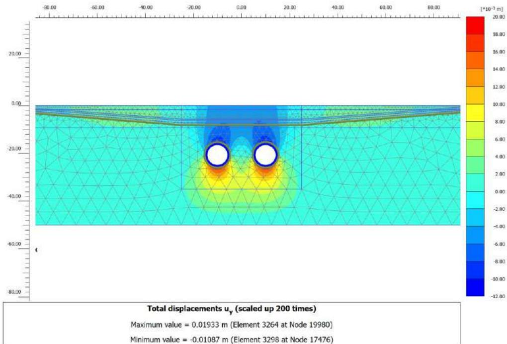
Figura 11-74: Infrastruttura L. Modello MC. Risultati. Campo deformativo. Scavo BP+BD
