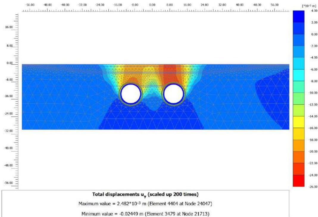
**Figura 11-15: Infrastruttura H. Modello SS. Risultati. Campo deformativo. Scavo BP+BD**
