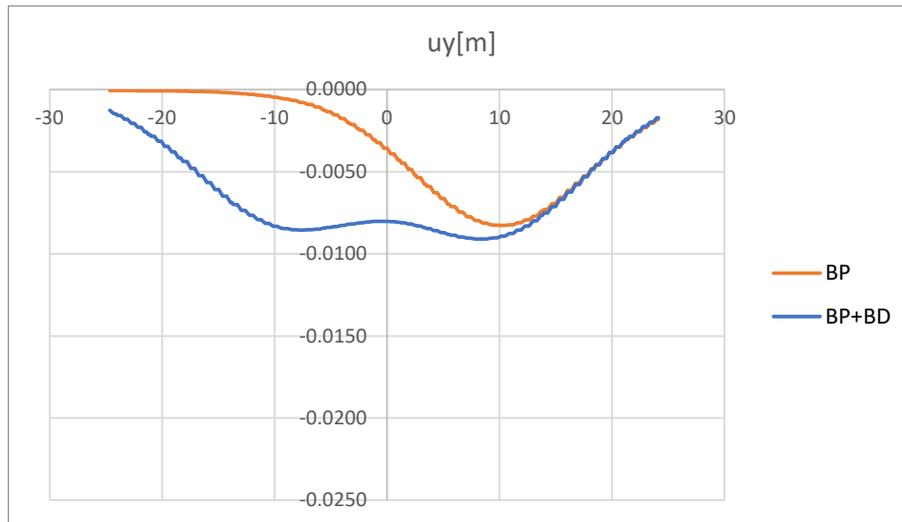
Figura 11-31: Infrastruttura M. Modello MC. Risultati. Spostamenti verticali
