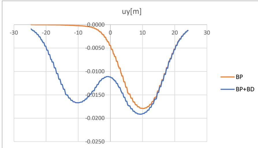
Figura 11-44: Infrastruttura M. Modello SS-rampa. Risultati. Spostamenti verticali
